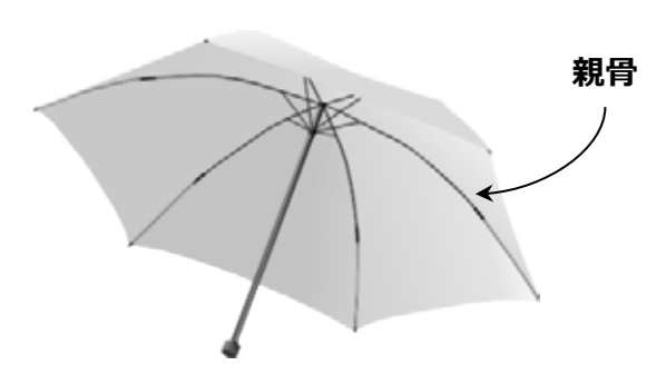
図：ガラス繊維強化プラスチックが使われている部位
